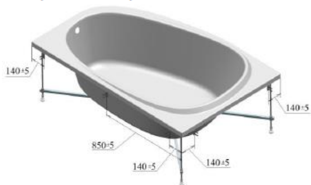
Рисунок 4 – Схема расположения креплений кронштейнов к стене
